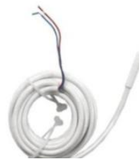
Sensore esterno Tipo NTC 10 k \Omega a 25 °C ( \beta = 3950)
