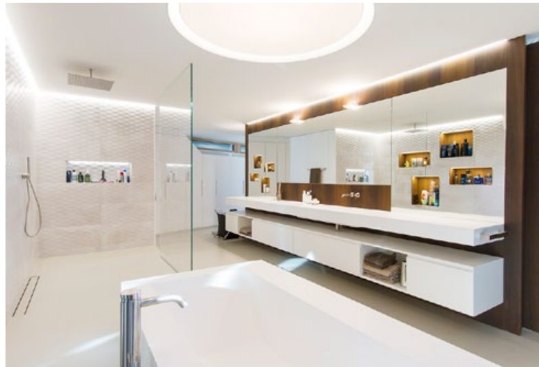
Der lange Waschtisch und das Unterbaumöbel im Elternbad sind nach Mass aus Mineralguss gefertigt.
